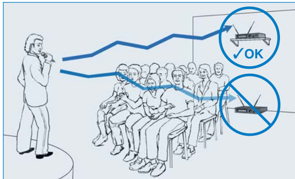
Colocación correcta e incorrecta del receptor y antenas
